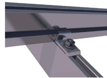
Detalle fijación G1 a triángulo
