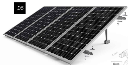
Kit 1 - Fijar las uniones del perfil guía inferior mediante los tornillos de fijación (2 a cada lado de la unión) Repetir en perfil guía superior.
