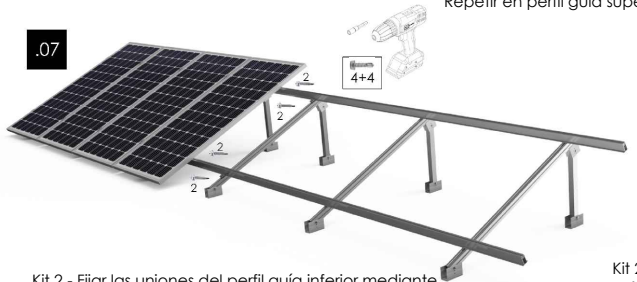
Kit 2 - Fijar las uniones del perfil guía inferior mediante los tornillos de fijación (2 a cada lado de la unión) Repetir en perfil guía superior.
