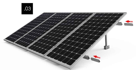
Kit 1 - Colocar las uniones (x2) suministradas en el Kit de unión en el interior de los perfiles guía del Kit 1
